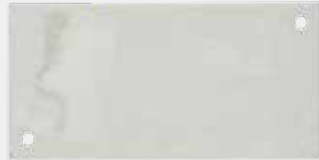
Abb.: Aluminiumplatten mit farbiger Eloxal-Schicht nach 80 Reinigungszyklen in baugleichen RDGs.
