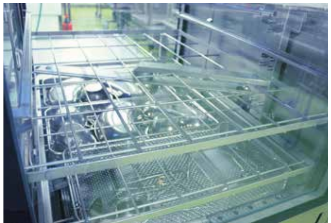
Reinigungs- und Desinfektionsgerät in der ZSVA Hessisch Lichtenau
