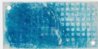
Abb.: Aluminiumplatten mit farbiger Eloxal-Schicht nach 80 Reinigungszyklen in baugleichen RDGs.
