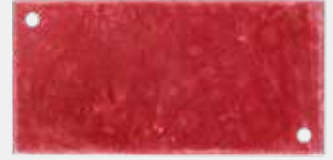
Abb.: Aluminiumplatten mit farbiger Eloxal-Schicht nach 80 Reinigungszyklen in baugleichen RDGs.
